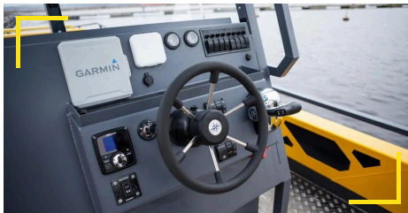
Der Steuerstand mit Steuerrad, Motorbedienung und Schalttafel
