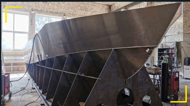
Der Rumpf in seiner Bauvorrichtung, mit Querspanten und Aussparungen über die ganze Länge.
